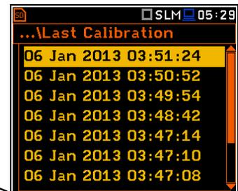
Para revisar los registros de calibración, el usuario tiene que seleccionar la línea deseada en la ventana **Last Calibration** y pulsar <ENTER>. La ventana abierta contiene la fecha y hora de la medición de calibración realizada, la forma en que la calibración se llevó a cabo (**Calibr. by Measurement** o **Calibr. by Sensitivity**), y el nivel de calibración deseada (Cal. Level) en el caso de las mediciones y el factor de la calibración obtenida (**Cal. Factor**).
