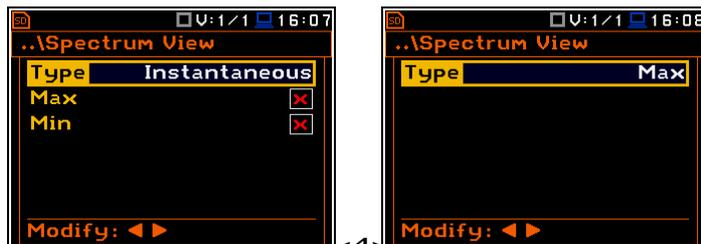
Los espectros de mínimo y máximo se pueden presentar en la misma grafica como espectro principal cuando el parámetro **Max** o **Min** está activado. Una línea roja muestra los niveles máximos en todas las bandas, mientras que una línea azul muestra los niveles mínimos, si es seleccionado por el usuario.
