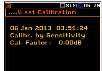
Si no se realizaron las medidas de calibración, la ventana **Last Calibration** no contiene ningún registro de calibración anterior. El contenido de esta ventana se borra después de la operación **Factory Settings**.
