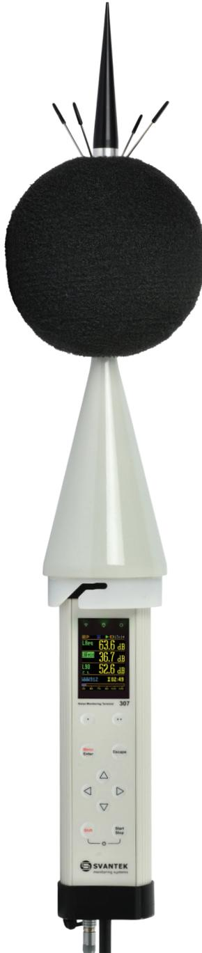
El SV307 está equipado con un nuevo micrófono MEMS con **garantía de por vida**. Los datos de medición se almacenan en la tarjeta Micro SD.
