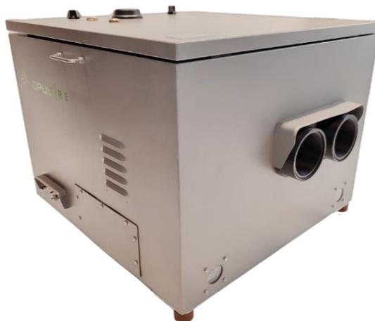
Las mediciones anteriores resultan en la determinación automática de las concentraciones de contaminantes en relación con el CO<sub>2</sub>: CO/CO<sub>2</sub>, NO/CO<sub>2</sub>, NO<sub>2</sub>/CO<sub>2</sub>, HC/CO<sub>2</sub> y NH<sub>3</sub>/CO<sub>2</sub>. También proporciona un "Factor de Humo" (SF), que evalúa las emisiones de partículas de escape del vehículo
