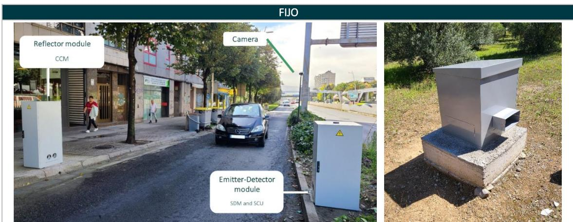
El RSD6000 puede alojarse en armarios de tráfico, que se anclan a los lados de la carretera. Esta configuración requiere una instalación de los armarios, pero permite disponer de un sistema fijo para medir ininterrumpidamente, 24 horas al día, 7 días a la semana, en un lugar específico.
